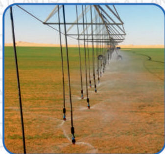
SR100 Canon d'extrémité de pivots d'origine et arroseur haut débit classique pour arrosage sectoriel. 50 GPM-300 GPM (11.4 M3/H-68.2 M3/H)
